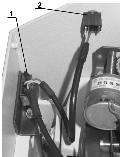
Рис. 7.7. Микропереключатель датчика установки кассетодержателя и гнездо кабеля кассетодержателя
